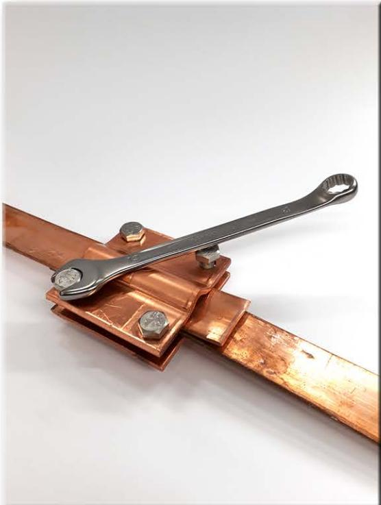
Die beiden Enden der Erdbänder mittels Verbindungselement verbinden. Im Bereich der Verbindung dürfen keine Hohlräume entstehen.
