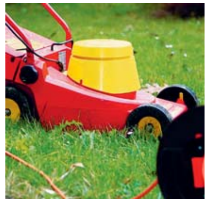
Bild 3: Fatale Gefahr, besonders wenn der FI-Schutzschalter fehlt.
